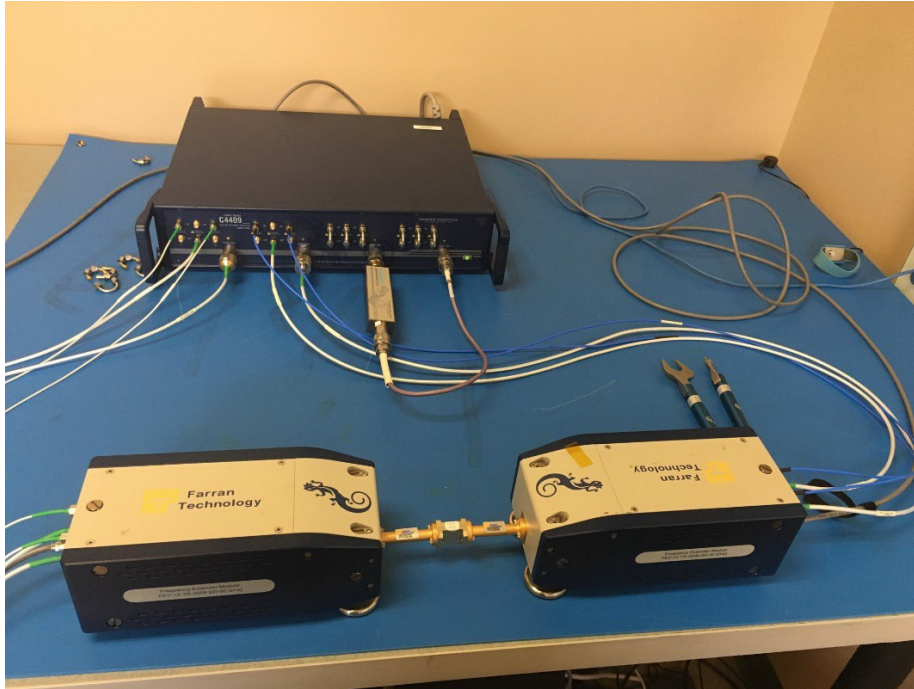
Figura 1: Los extensores FEV-12 se muestran conectados a los puertos 1 y 2, mientras que los puertos 3 y 4 están conectados al filtro de paso de banda de 500 MHz
