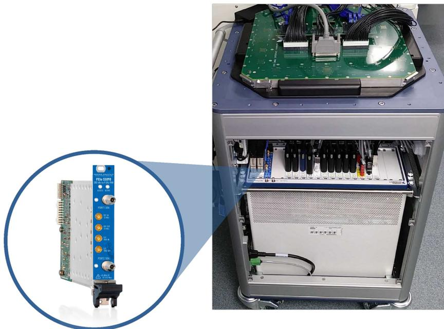
*Figura 2 Sistema NI STS ATE, panel lateral retirado para mostrar CMT S5090 instalado en el interior, cables SMA al lado inferior de la placa de carga*
